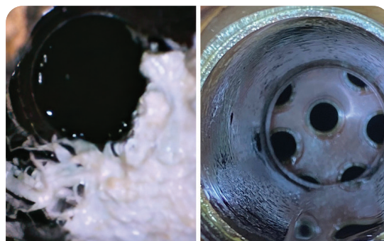
Tubi dello scambiatore di calore prima e dopo l'utilizzo continuo del generatore di nanobolle.
