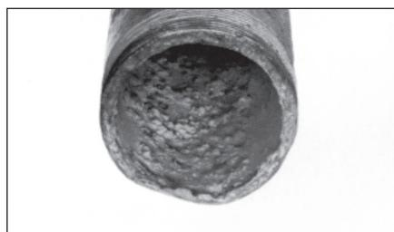
**Figura CG-11-3.** Oxigênio no sistema acelera a corrosão (oxidação) dos tubos, causando a formação de alvéolos ("pites") como mostrado aqui.
