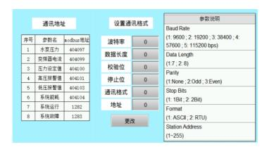
在地址表中设置 MODBUS 地址和通讯参数, 方便中控远程连接, 读取主机的参数。
