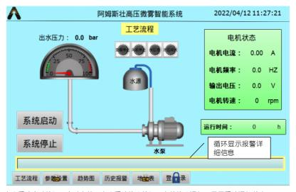
点击系统启动按钮, 启动主机, 点击系统停止按钮, 主机停止运行; 显示系统运行状态。
