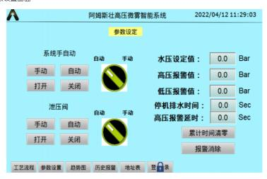
此画面设置各个参数值, 手动启动主机和泄压阀, 清除报警。
