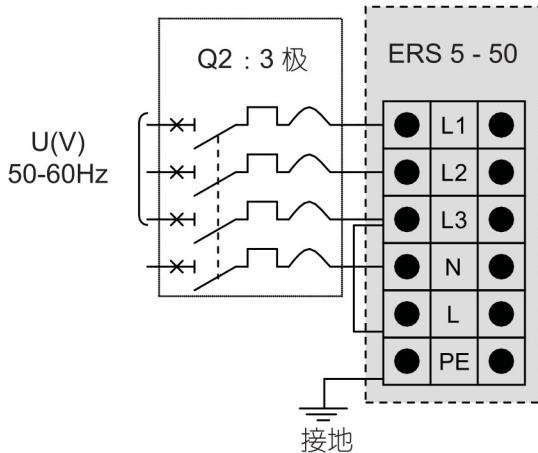
Q1 和 Q2 之间的符号  $\Delta$  表示这些 MCB 已耦合。电源 MCB Q2 和控制器 MCB Q1 以机械方式连接在一起。因此，如果检测到故障，则电源和控制电路将关闭，且设备上没有电压。装置已确实断电。
