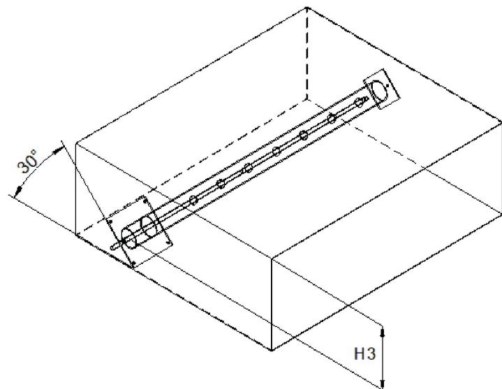
在高度有限的风道中，布汽管可以倾斜  $30^\circ$ ，以获得 80 毫米的最小高度。
