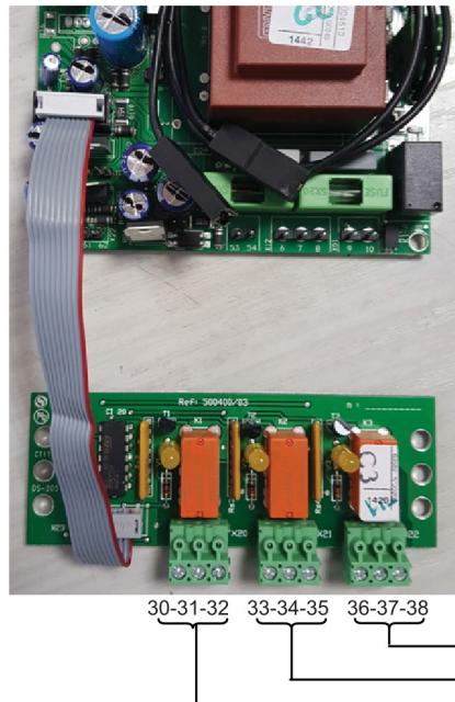
根据下面的接线图，可以通过调整布线来调整触点
