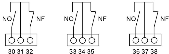
X22 接头 (36-37-38) : 远程蒸汽产生，干触点。
