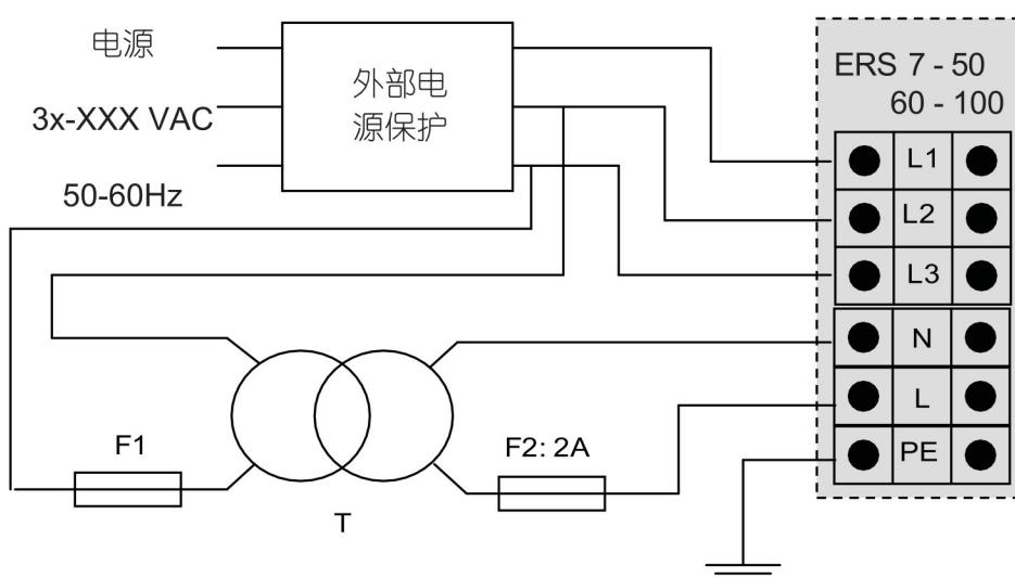
以下选配件的连接必须使用最大  $0.75 \text{ mm}^2$  的柔性电缆。
