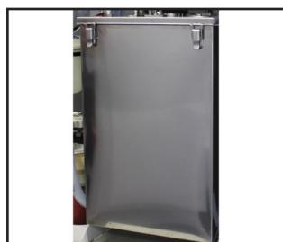
4. 将带有电阻加热元件的盖子归位：确保将其放回初始位置，并确定水箱和设备底部之间没有电线缠绕。为此，必须用提供的电缆夹将为电阻器供电的电线整理归位（见图 12）。
