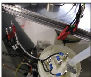
6. 卸下水箱的 4 个闭合夹 — 正面 2 个，背面 2 个（图 5）。
