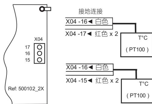
2. 温度传感器故障。断开温度传感器与 X04 接头的连接，并用万用表测量 PT100 的欧姆值。
