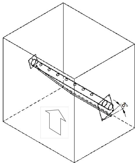
在气流向上或向下的垂直风道中，蒸汽布汽管必须向侧面倾斜  $15^\circ$ 。
