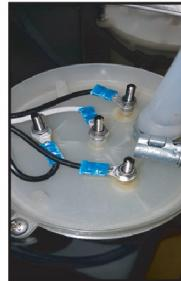
3. **温度传感器故障或需要重新校准。** 如果在水箱冷却状态出现此消息，则必须测试和更换温度传感器 (PT100)。然后重新校准。
