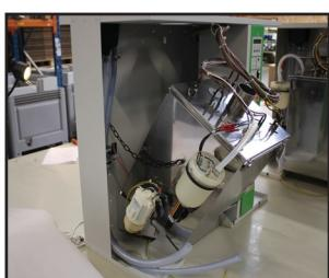
4. 拧下水箱下部的黑色旋钮。松开活接头（图 3-a）和水箱上的供水软管（图 3-b），以断开排水管的连接。
