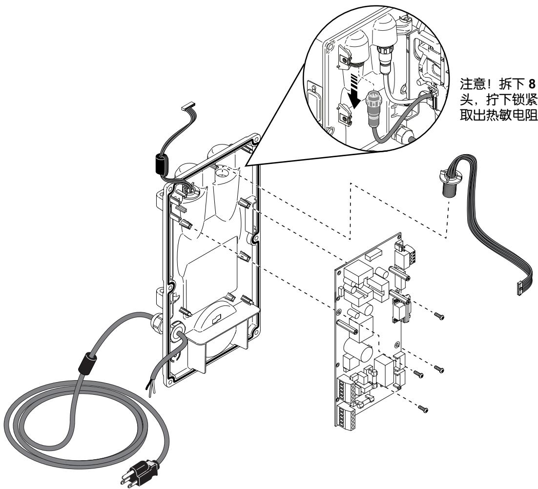
注意！拆下 8 针插头，拧下锁紧螺母，取出热敏电阻束
