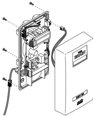
断开并卸下电子模块之前先切断 DRV80 的电源，请参阅第 40-43 页。调整 PCB 上的亮度设置并重新连接电子模块。
