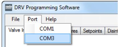
通过选择正确的 **COM** 端口找到 DRV80。可以使用 Microsoft Windows OS 中的 **Device Manager** (设备管理器) 实用程序确认 **COM** 端口。
