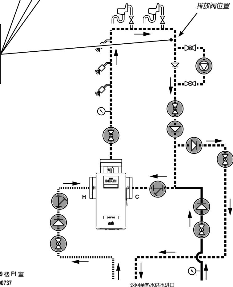
故障：“混合电路温度读数和DRV80 温度显示之间的恒定差异...”
