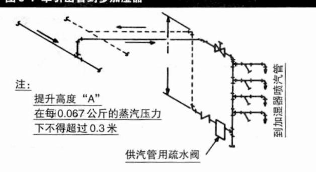
图 8-5 型号 93/1300 和 94/1400 高排量对比低排量的不同接管选择
