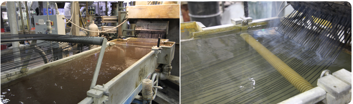
Extrusionsbad von und nach der Installation des Boosters für den Nanoblasengenerator von Armstrong (19,05 x 38,1 mm (3/4" x 1,5")).
