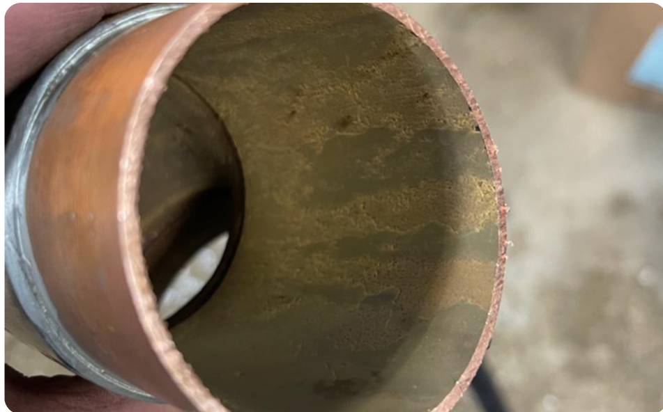
Memorial Healthcare의 생활용 온수 시스템 배관 샘플에서 스케일을 제거하기 시작한 나노버블.
